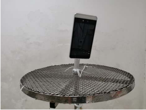
防水测试后，没有水渗入
