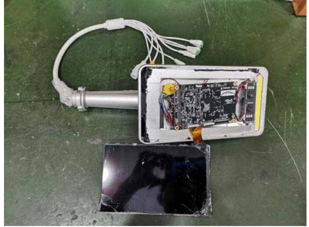
防水测试后，没有水渗入
