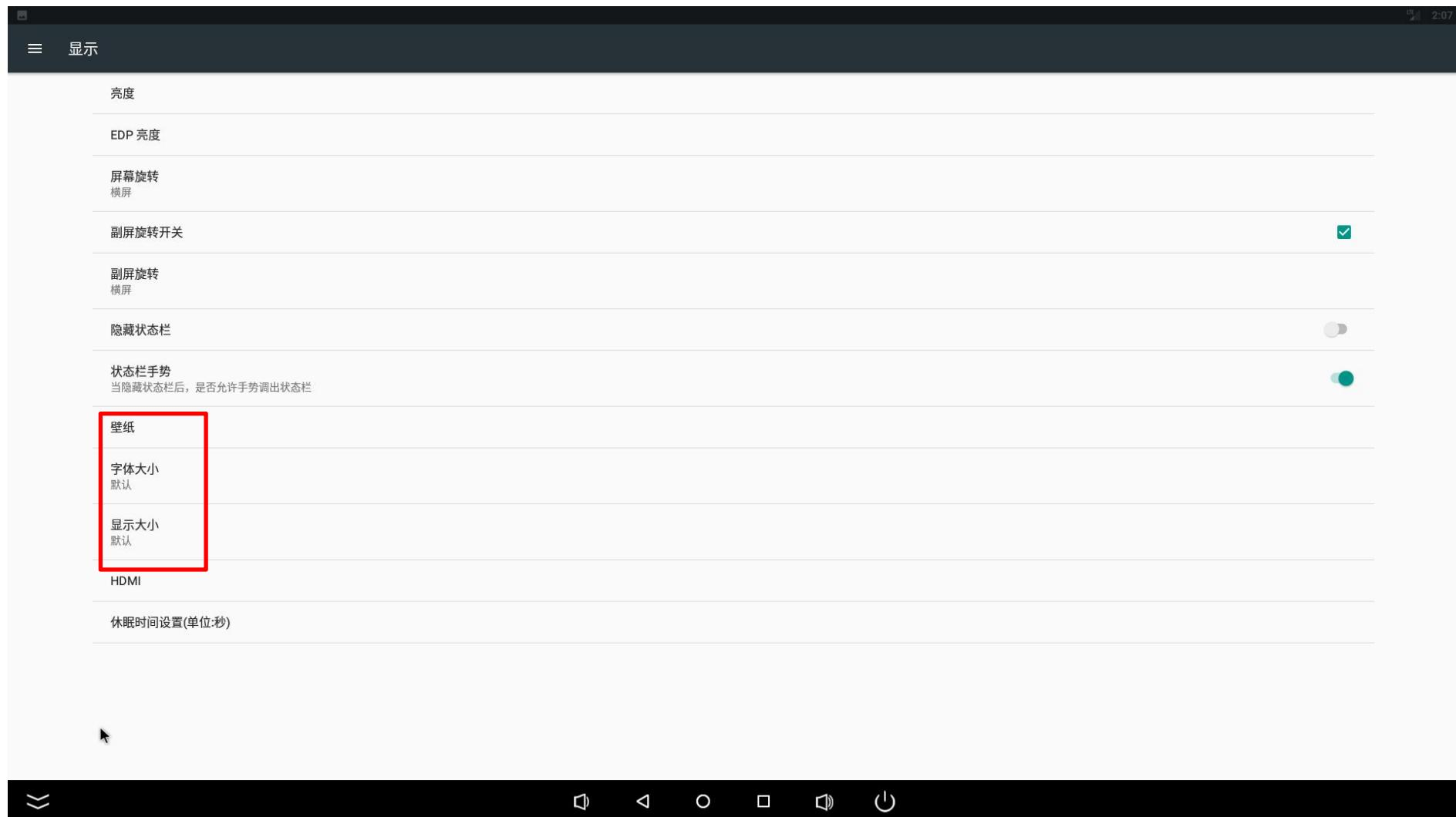
点击【显示】-【HDMI】，点击右上角，可开启HDMI输出功能，点击【分辨率设置】可设置输出分辨率。
