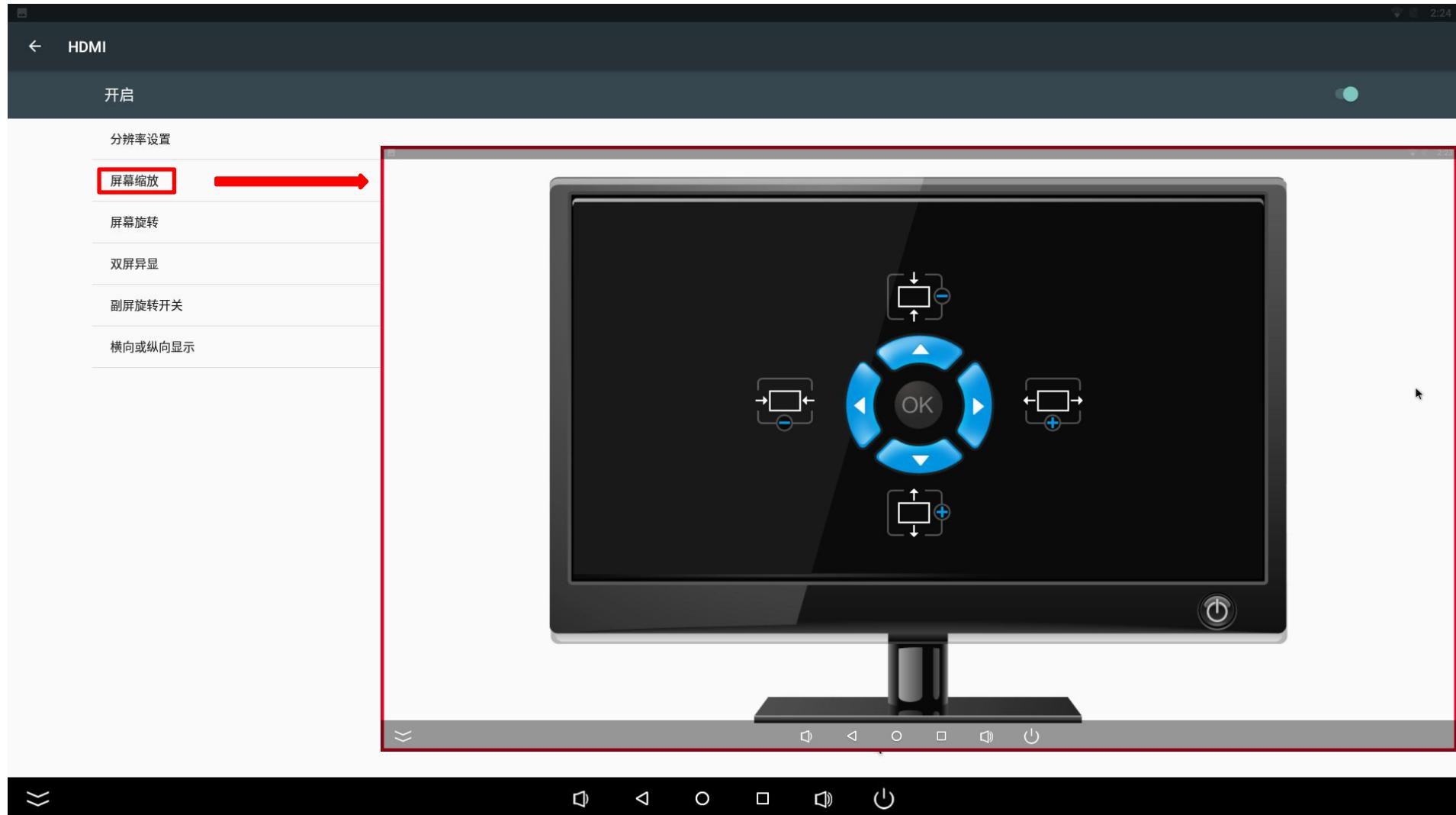
点击【屏幕旋转】可旋转屏幕，支持0°、90°、180°、270°旋转。
