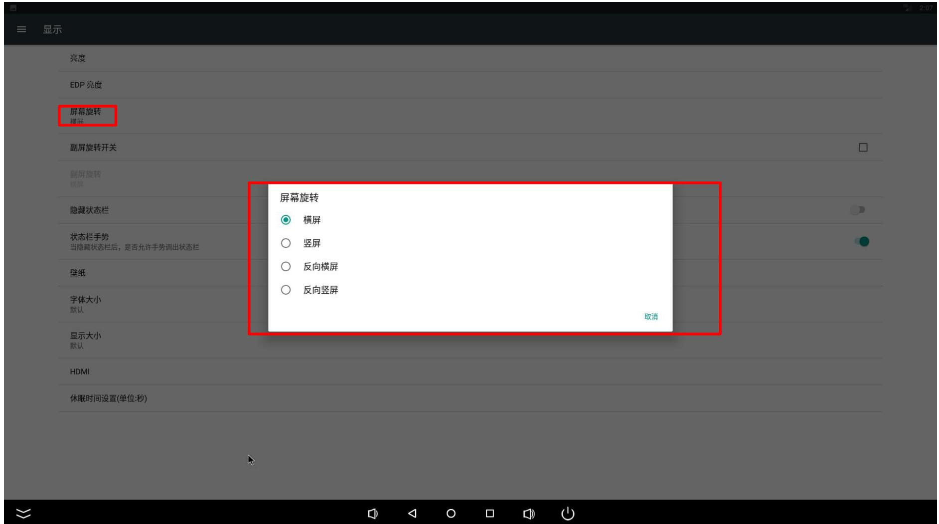
点击【副屏旋转开关】，可旋转副屏屏幕，支持横屏、竖屏、反向横屏、反向竖屏。
