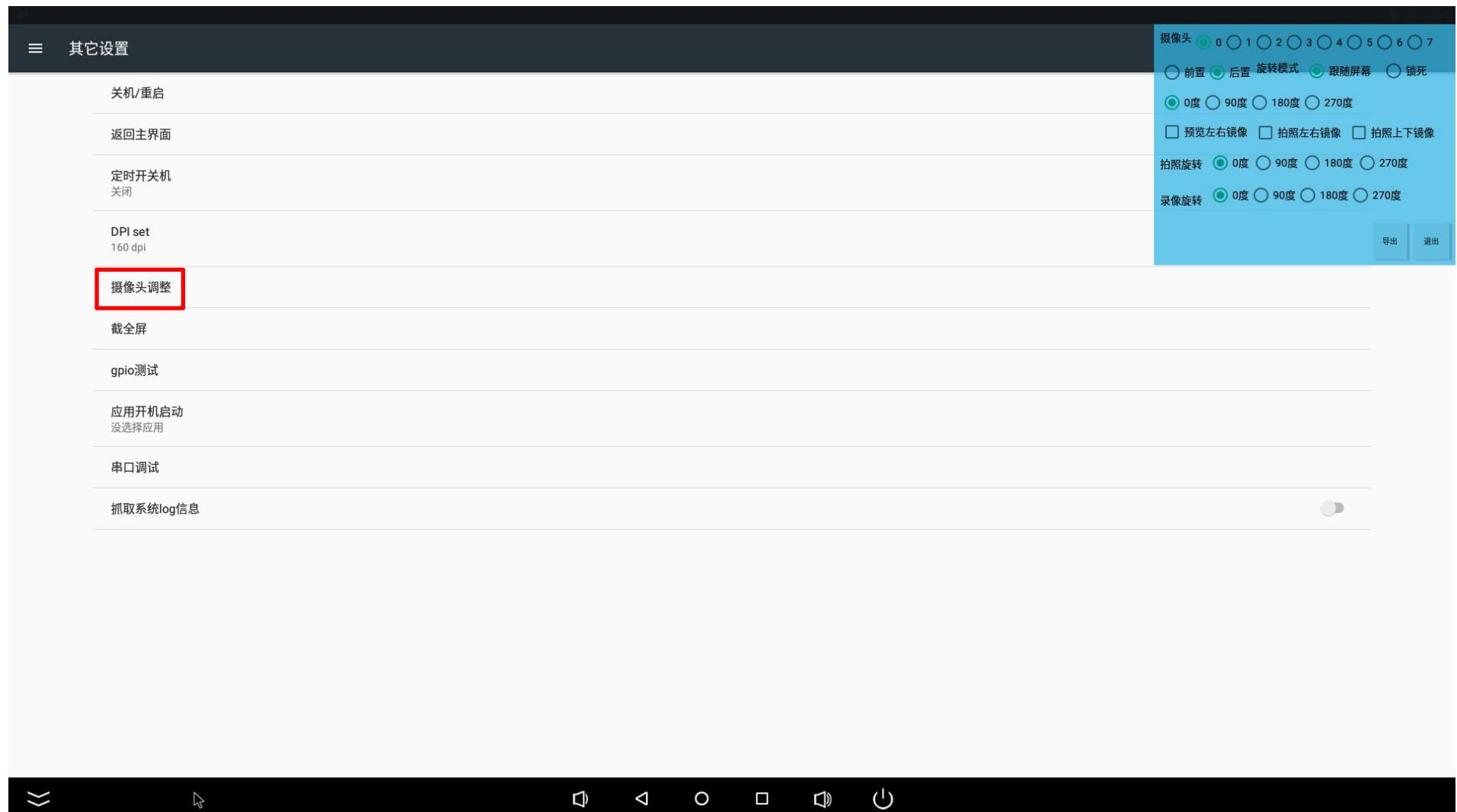
点击【GPIO测试】，可以设置内部主板GPIO口和外部主板GPIO口。
