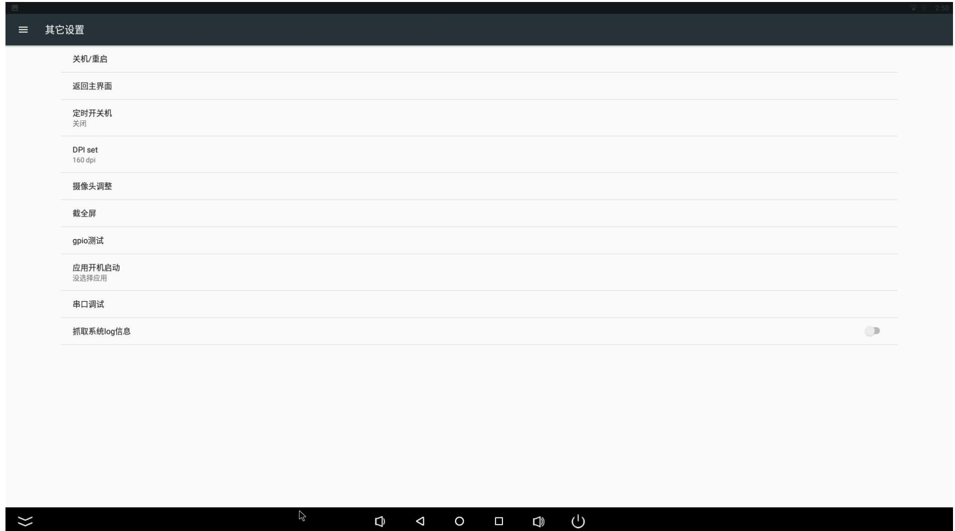
点击【摄像头调整】，可以设置前置、后置摄像头、跟屏或锁死，以及旋转摄像头的角度等。。
