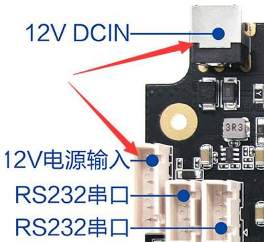
电源插座的接口定义如下，可以采用电源板供电，座子规格为 6PIN 2.54mm 间距。
