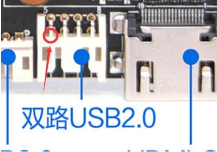
单排 USB 4Pin 2.0mm 间距插座\*3, 电气定义如下:
